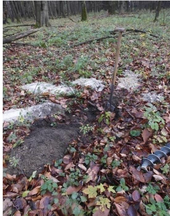
**Abb. 21:** Ein Bohrpunkt, nur 25 m vom Bachlauf entfernt, weist einen herbstlichen Grundwasserstand von 2,60 m unter Flur auf. (Revier Hornow, Abt. 664)
